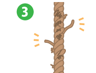
錆及び錆びた摩耗粉の状況
